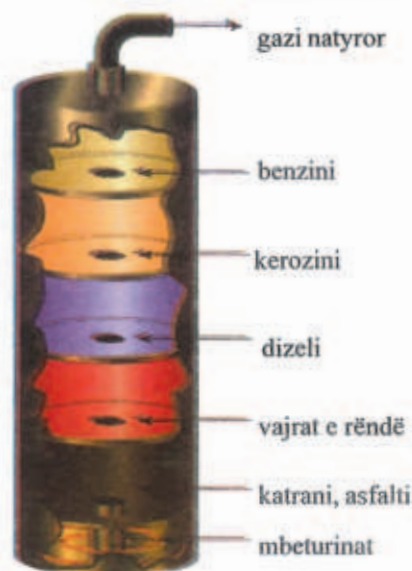
Fig. B.18. Rafineria e naftës dhe kolona e distilimit fraksional të naftës.
