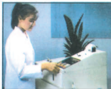
b) Njëri prej aparateve bashkohore në laboratorin e kimisë organike. është C-H analizatori
